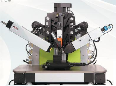
Немецкая компания Accurion — производитель уникального по своим характеристикам оборудования для измерений в тонких пленках — спектральных визуализирующих эллипсометров, микроскопов угла Брюстера, рефлектометров. В визуализирующих эллипсометрах Accurion одновременно используются технологии классической эллипсометрии и оптической микроскопии, что позволяет измерять свойства поверхностей и границ раздела сред с высокой точностью и исключительным латеральным разрешением.
